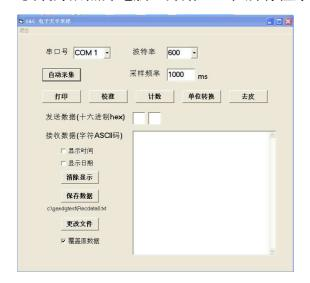
3.电子天平和电脑之间插好连线,打开天平电源开关,如下图那样选择串口和波特率。
